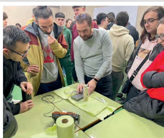
Demostración de la aplicación del método de ultrasonidos, realizada por Ignacio González, sobre una pieza laminada
