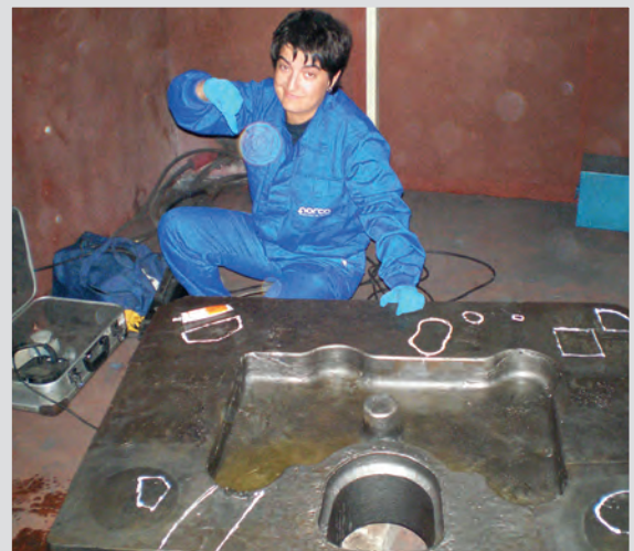
Figura 2. La autora realizando partículas magnéticas en troquel fundido
